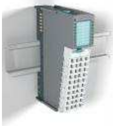
Das Modul mit 16 Kanälen ist deutlich schmaler als zwei 8-Kanal-Baugruppen
